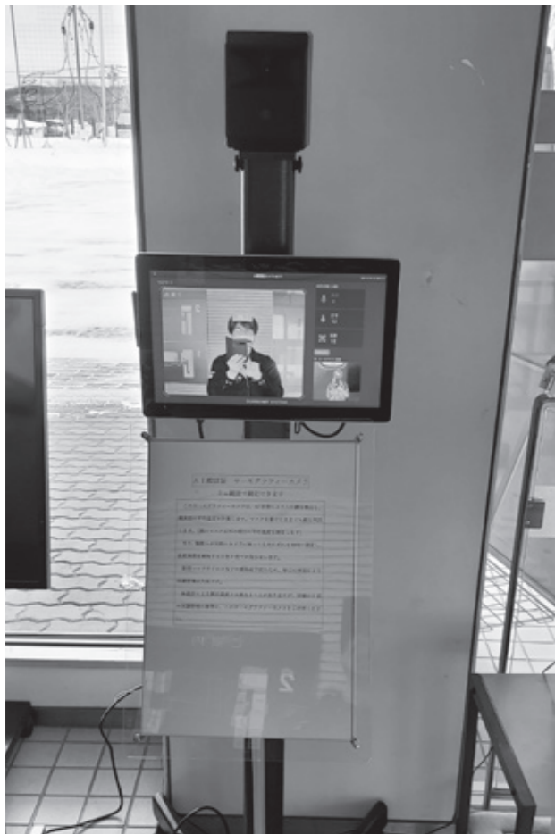
役場入り口に設置されているサーモグラフィカメラ
