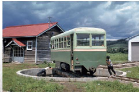
転車台で方向転換する単端式(運転台が片側のみ)の「若鶴号」
