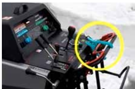
デッドマンクラッチ機構を大きな洗濯バサミで固定
