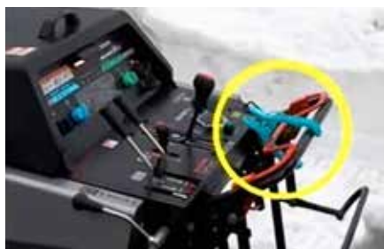
デッドマンクラッチ機構を大きな洗濯バサミで固定
