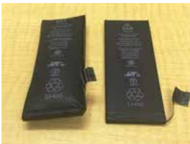
※膨張した電池(左側)
