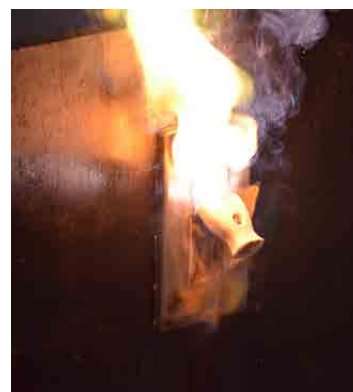
コンセントからの出火によるトラッキング現象を再現
