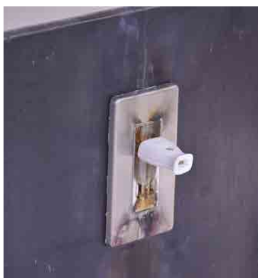
コンセントからの出火によるトラッキング現象を再現
