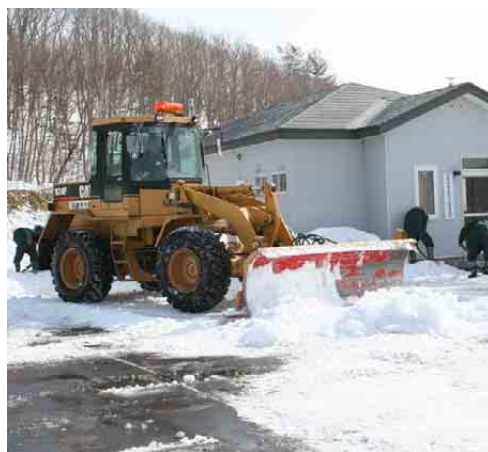
重機や作業員による除雪作業の様子
